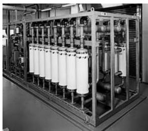
膜ろ過浄水装置
