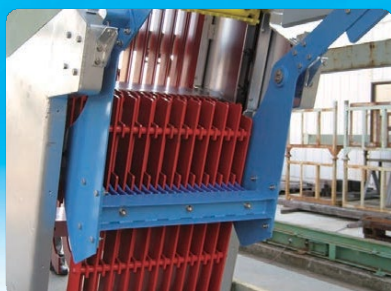
2 ตะแกรงเคลื่อนที่แบบแอมป์สวิงและส่วน หลังตะแกรงหลังตะแกรง
